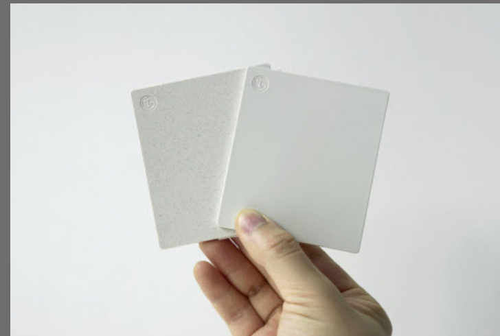
PCR-ABS(왼쪽)과 기존 ABS(오른쪽) 외관 상 큰 차이가 없다.
