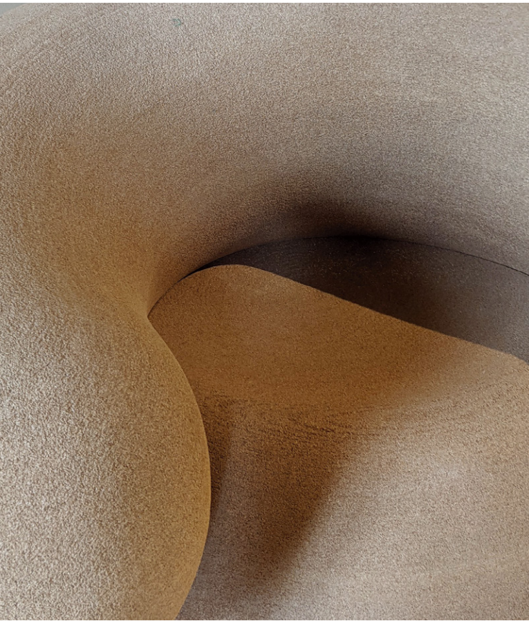
← EconitWood™ 에코니트우드 지역의 열등 원목과 미네랄을 결합한 신소재로 3D 프린팅 기술을 통해 대규모의 복합적 구조를 폐기물 없이 생산 econit.info
